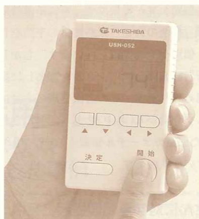
●図 膀胱内尿量測定器「ゆりりん®」(タケシバ電機)
